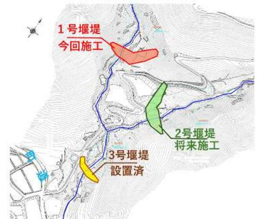
図-1 足尾谷川砂防堰堤平面図
