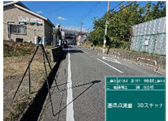
図-8 TLSによる基準点測量 ワンマンでも作業可能
