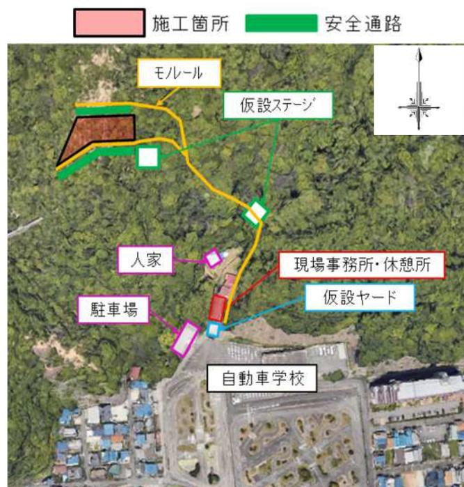
図-1 施工箇所図
