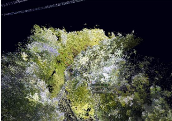
図-5 フィルタリング前の点群データ
