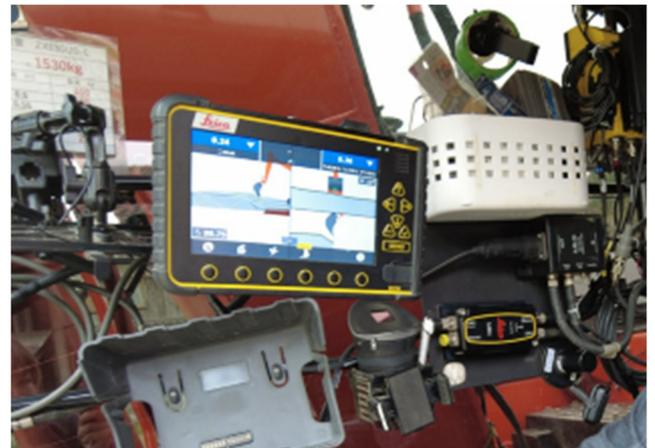
図-14 重機内のマシンガイダンスの様子
