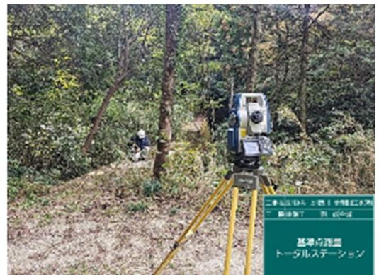
図-10 従来の2名1組のTSでの測量風景
