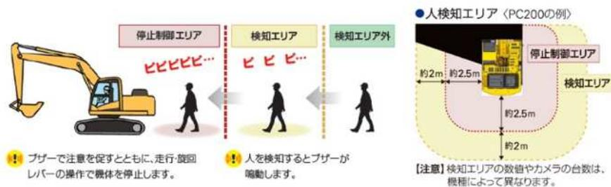
図-3 人検知衝突軽減システム
