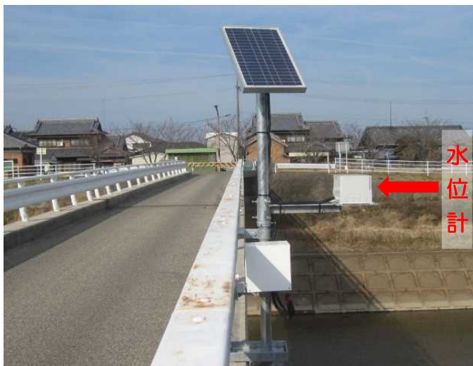
写真-3 危機管理型水位計 (神内川)
