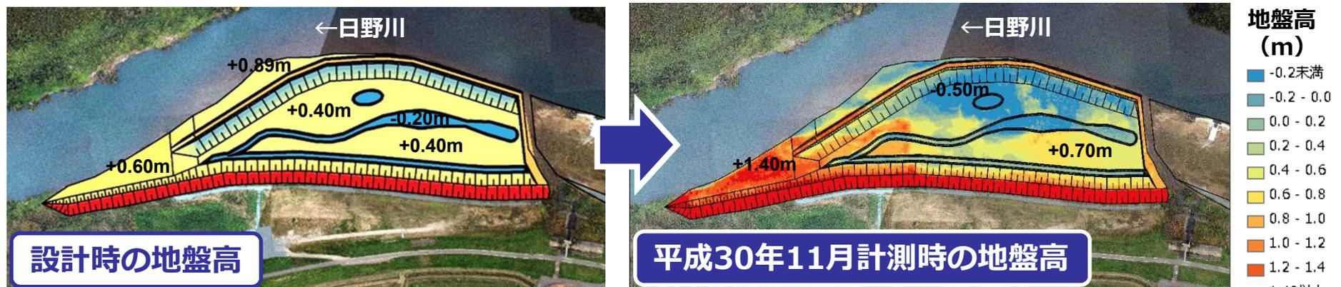
差分（平成30年11月計測時地盤高 - 設計時の地盤高）
