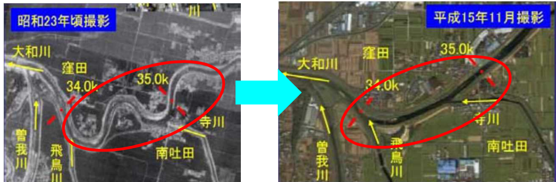
捷水路整備による河道の直線化
