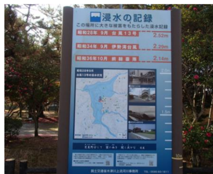
写真 4.3.2-4 浸水実績水位の表示例 (令和2年12月)
