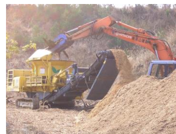
写真 4.6.2-2 流木の有効活用 (流木のチップ化)(平成 18 年 5 月)
