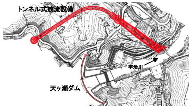
図 4.3.2-5 天ヶ瀬ダム再開発による放流能力の増強
