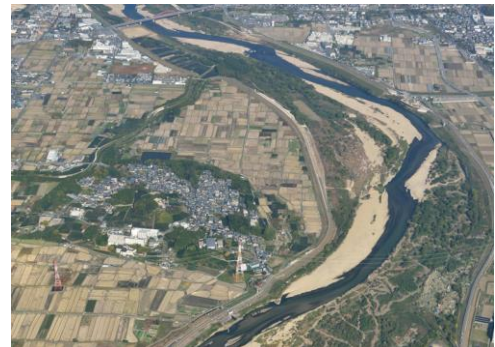
写真 3.2.1-1 陸域と水域の二極化(木津川) (平成 26 年 11 月)
