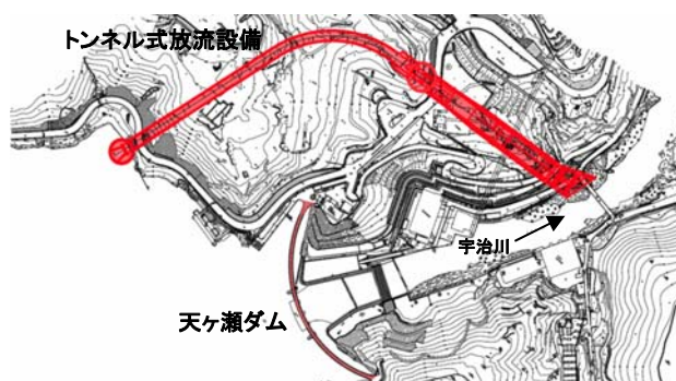
図 4.3.2-18 天ヶ瀬ダム再開発による放流能力の増強
