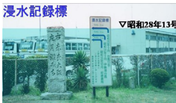
写真 4.3.1-2 浸水実績水位の表示例
