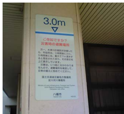
写真 4.3.2-3 洪水標識板(八幡市の事例)
