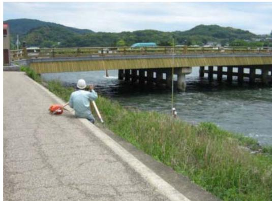
写真 3-4-1 レベル器による水位観測の状況
