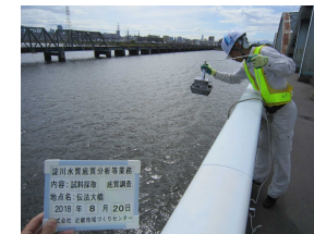
底質モニタリング (汽水域)試料採取状況
