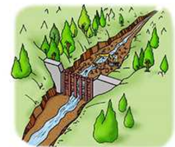
④ 堰堤にたまった岩、土砂や流木は、次の土石流に備えて取り除きます。
