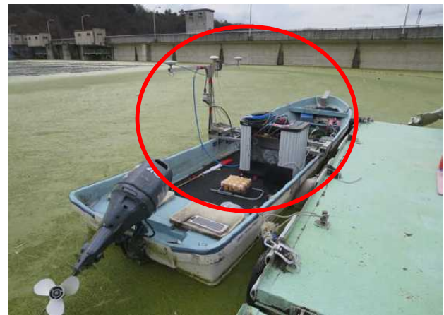
深浅測量(マルチビーム測深器)
