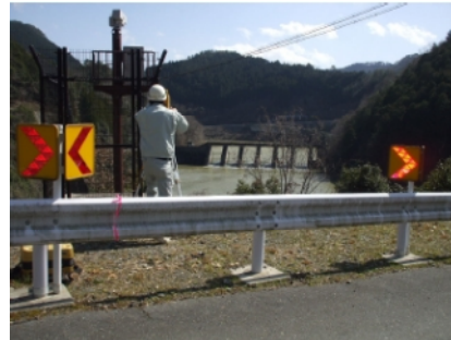
世木ダム堤体の変位計測
