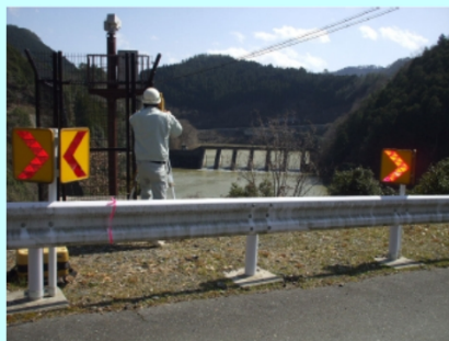
世木ダム堤体の変位計測
