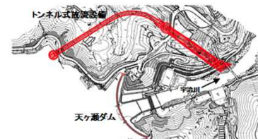
図 4.3.2-20 天ヶ瀬ダム再開発による放流能力の増強
