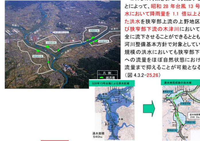
図 4.3.2-25 上野地区の浸水被害軽減を図る上野遊水地
