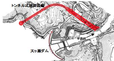
図 4.3.2-18 天ヶ瀬ダム再開発による放流能力の増強
