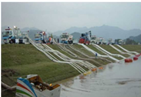
排水ポンプ車による緊急排水
