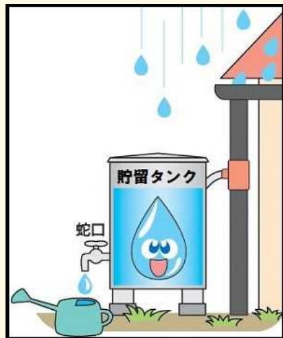
雨水貯留タンク（屋根に降った雨を貯めるタンク）
