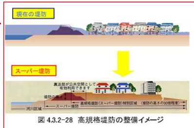
図 4.3.2-28 高規格堤防の整備イメージ
