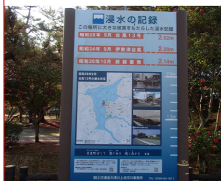
写真 4.3.2-2 浸水実績水位の表示例
