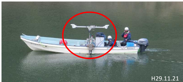
深淺測量(マルチビーム測深器)
