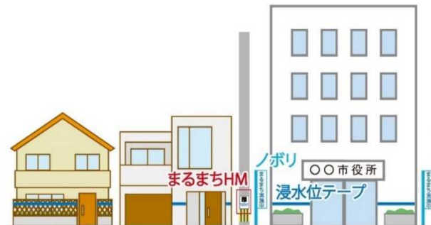
浸水深の線状設置イメージ
