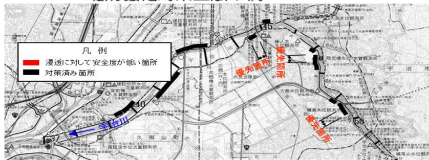
宇治川の堤防強化実施状況 (淀川本川については次ページ参照)
