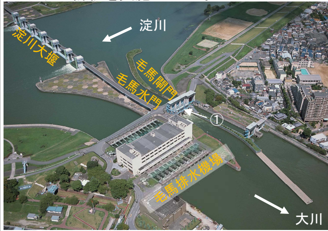
大川への流量調節を担う毛馬水門を境に淀川本川と大川に水位差が発生
