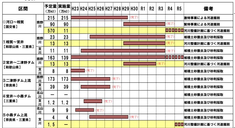
(国・県管理区間) 熊野川本支川の更なる → 治水安全度の向上を図 るため、継続して河道掘 削を実施
