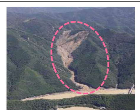
⑧野尻地区(被災直後) ・崩壊規模 20.44ha ・対策: 谷止工、山腹工
