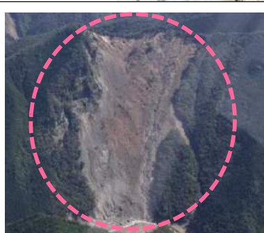
⑬赤谷地区(被災直後) ・崩壊規模 24.9ha ・対策: 山腹工
