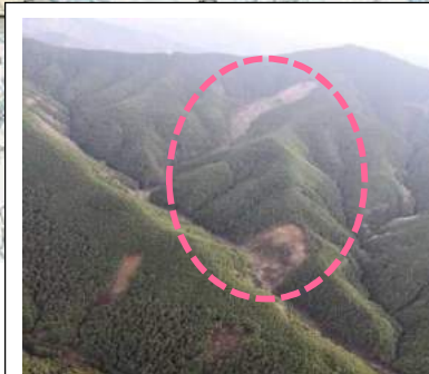
⑮栃尾(桑谷)地区(被災直後) ・崩壊規模 1.5ha ・対策: 谷止工
