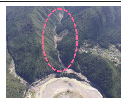
③高津地区(被災直後) ・崩壊規模 3.33ha ・対策: 谷止工、山腹工
