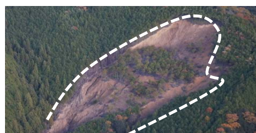
はっしょうまえ ②八升前区域(田辺市本宮町湯峯) ・崩壊規模 0.75ha ・対策工: 溪間工 山腹工
