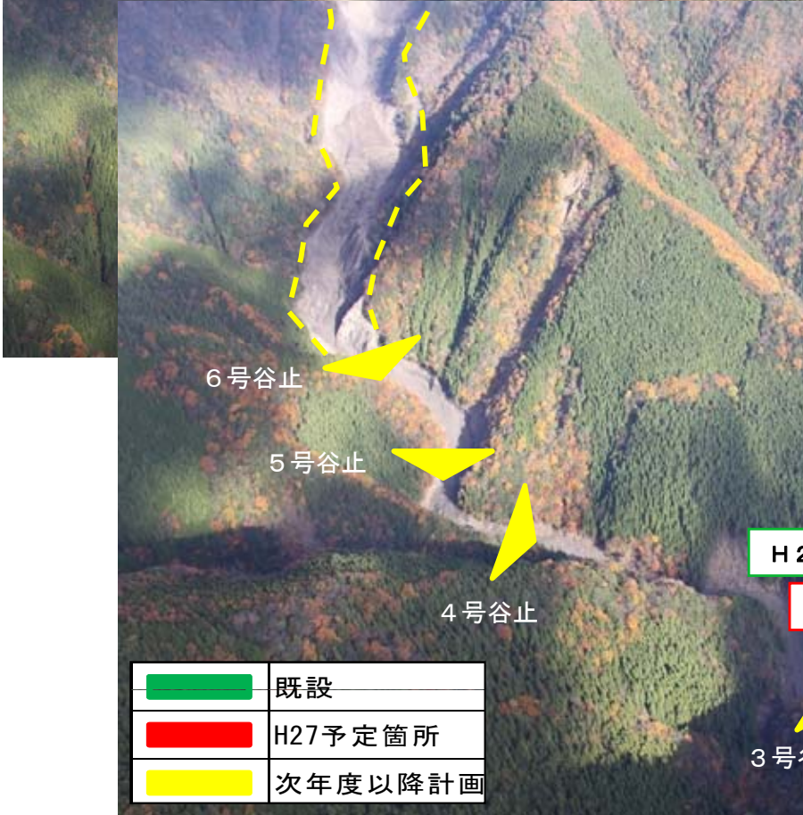
山腹崩壊地より流出した不安定土砂の状況
