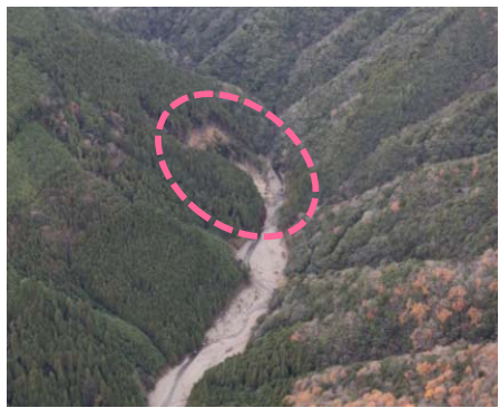
①三田谷地区(被災直後) ・崩壊規模 1.67ha ・対策: 谷止工、山腹工
