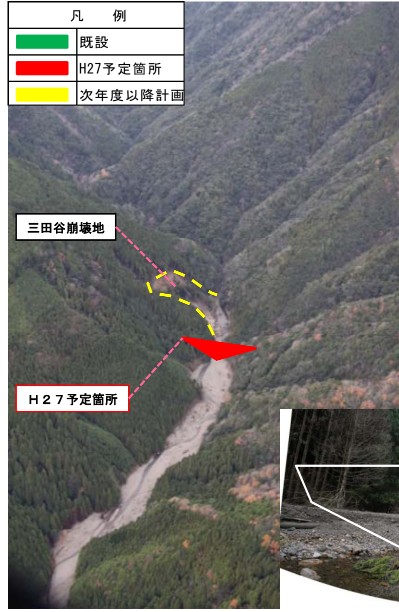
H27予定箇所の状況(第1号谷止工)
