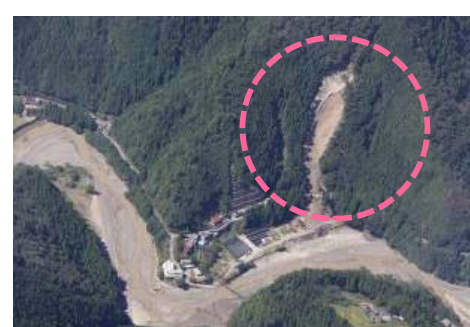
⑤五百瀬地区(1号地)(被災直後) ・崩壊規模 0.47ha ・対策: 山腹工
