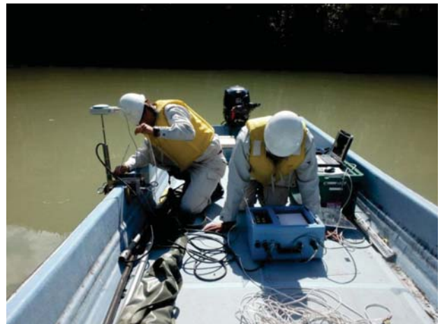
フェンス展張箇所での深淺測量
