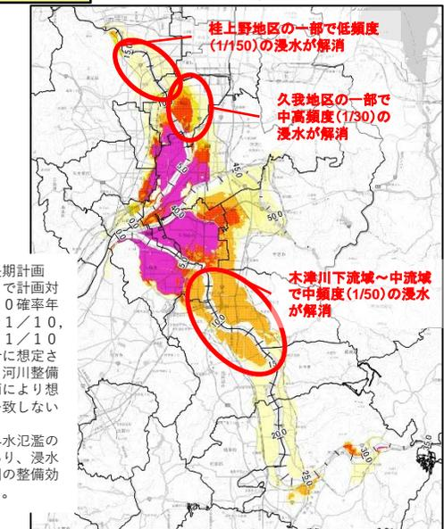
※この図は、河川の長期計画（河川整備基本方針）で計画対象としている1/150確率年の降雨及びその降雨を1/10、1/30、1/50、1/100の確率年とした場合に想定される浸水範囲であり、河川整備計画で目標とする降雨により想定される浸水範囲と一致しない場合があります。
