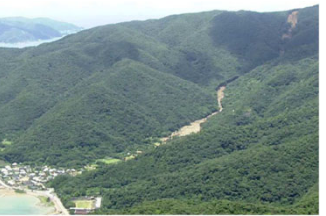
おおしまぐん せとうちちょう 6/21 鹿児島県大島郡瀬戸内町 山腹崩壊により農地等が被災
