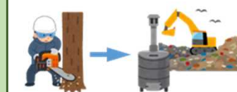
河道内樹木を伐採し洪水の疎通能力を向上
