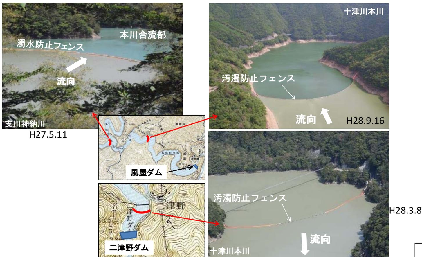
風屋ダム濁水防止フェンスの運用(運用方法)
