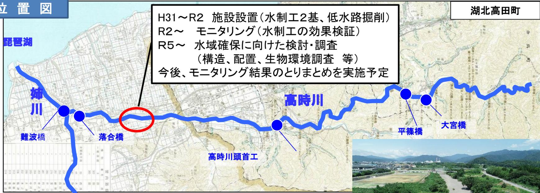
H31～R2 施設設置（水制工2基、低水路掘削）
