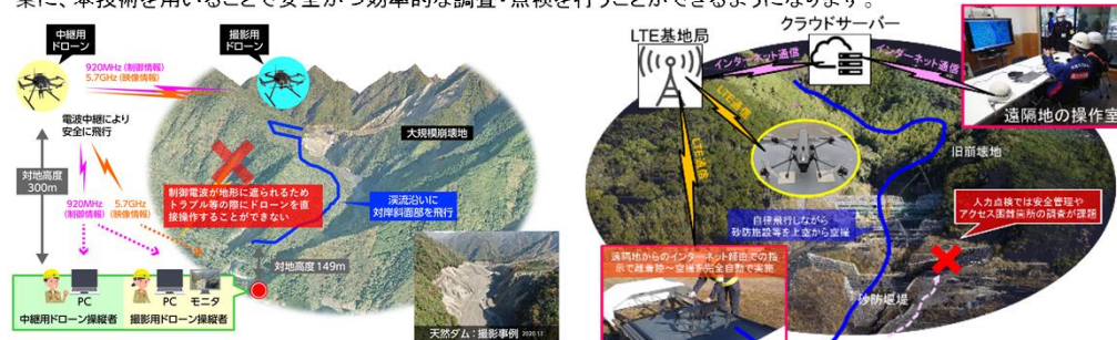
ドローン2機を併用した電波中継技術による崩壊地調査
