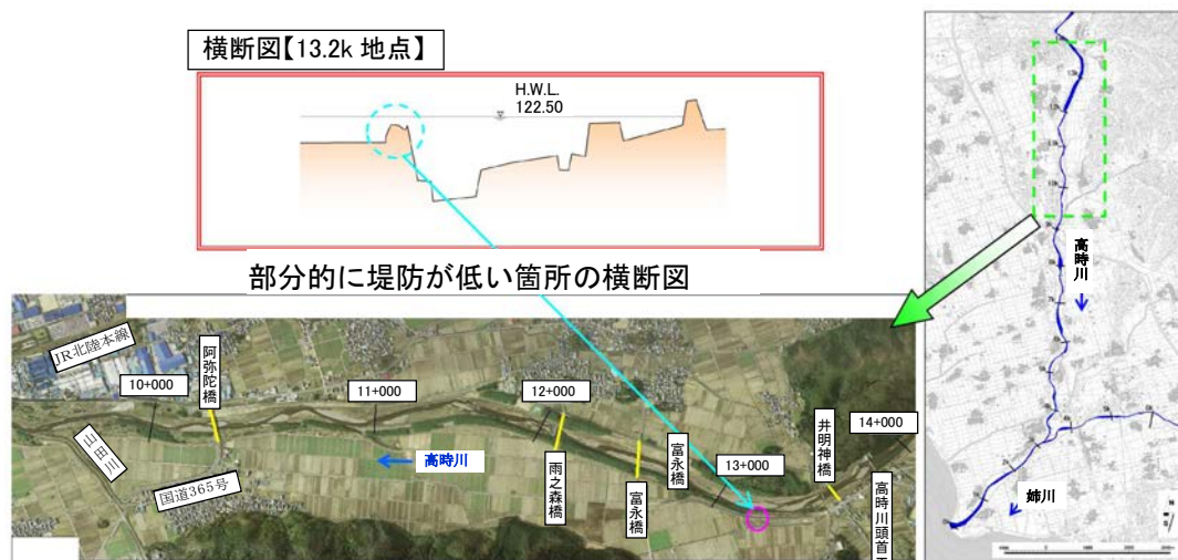
図 4.3.23 部分的に堤防が低い箇所の候補地
