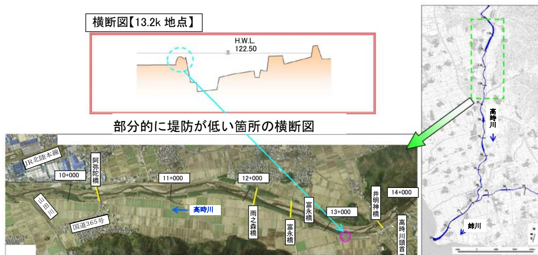
図 4.3.23 部分的に堤防が低い箇所の候補地
