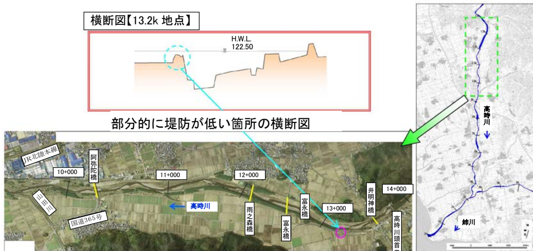
図 4.3.23 部分的に堤防が低い箇所の候補地
