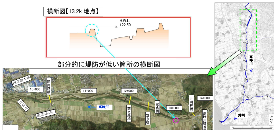
図 4.3.23 部分的に堤防が低い箇所の候補地
