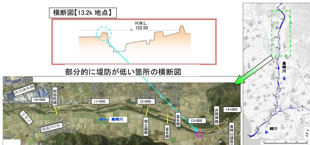
図 4.3.23 部分的に堤防が低い箇所の候補地
