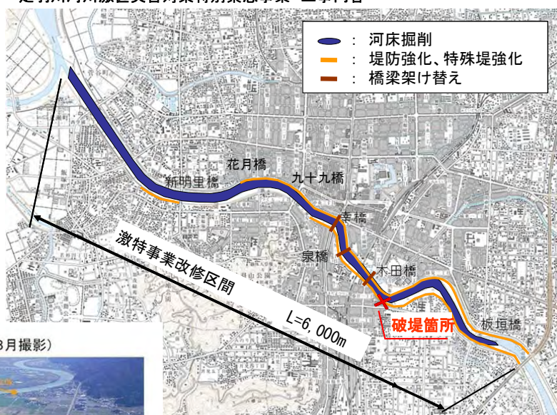
足羽川河川激甚災害対策特別緊急事業 工事内容
