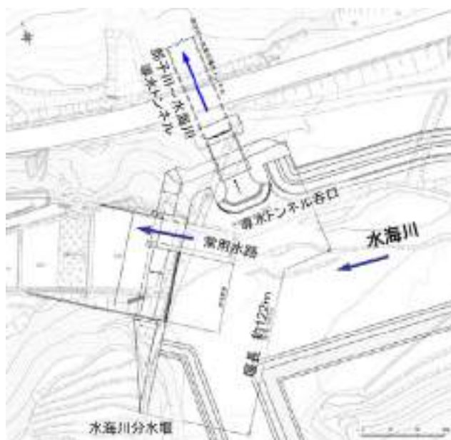
図 3-6 水海川分水堰平面図（左）と水海川導水トンネル断面図（右）
