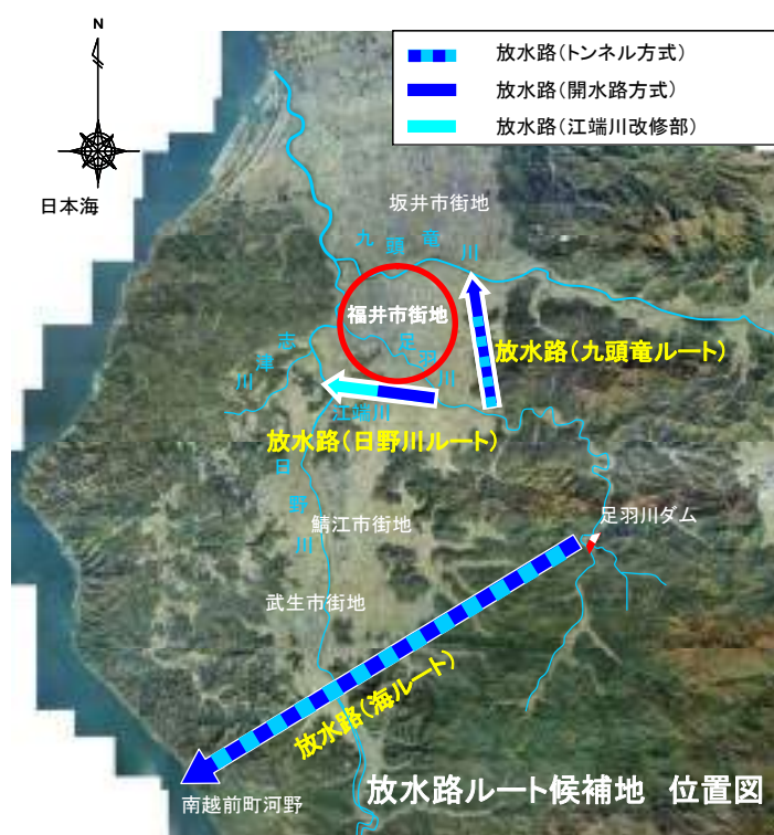
放水路(海ルート)イメージ (200m 3 /s規模のトンネル×3条)
