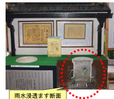
雨水浸透ますの例 (「雨水浸透施設の整備促進に関する手引き(案)」より)
