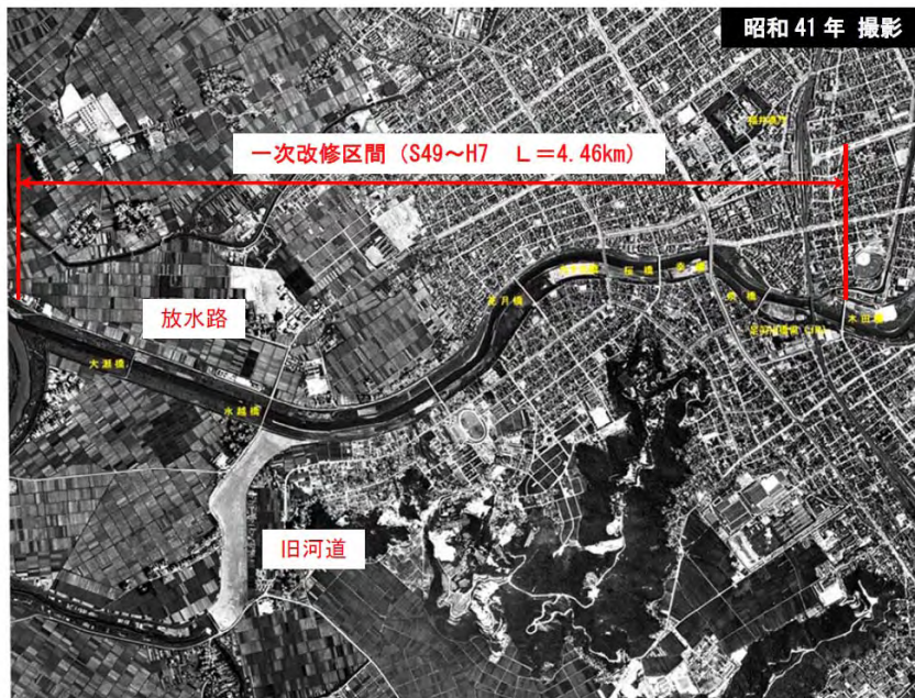
図 2-23 足羽川（下流の放水路開削区間）
