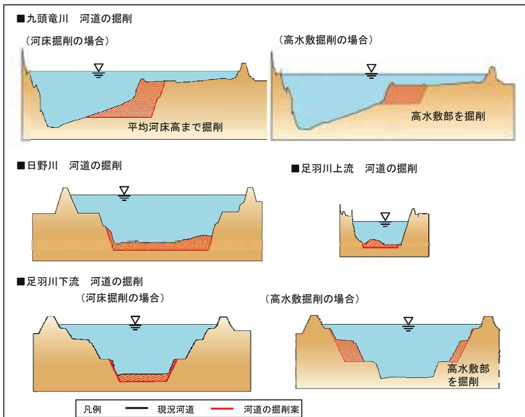
図 4-10 河道の掘削イメージ
