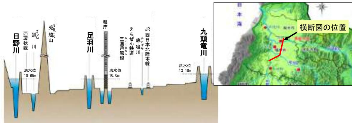
図 2-5 地盤面と河川水位の比較図
