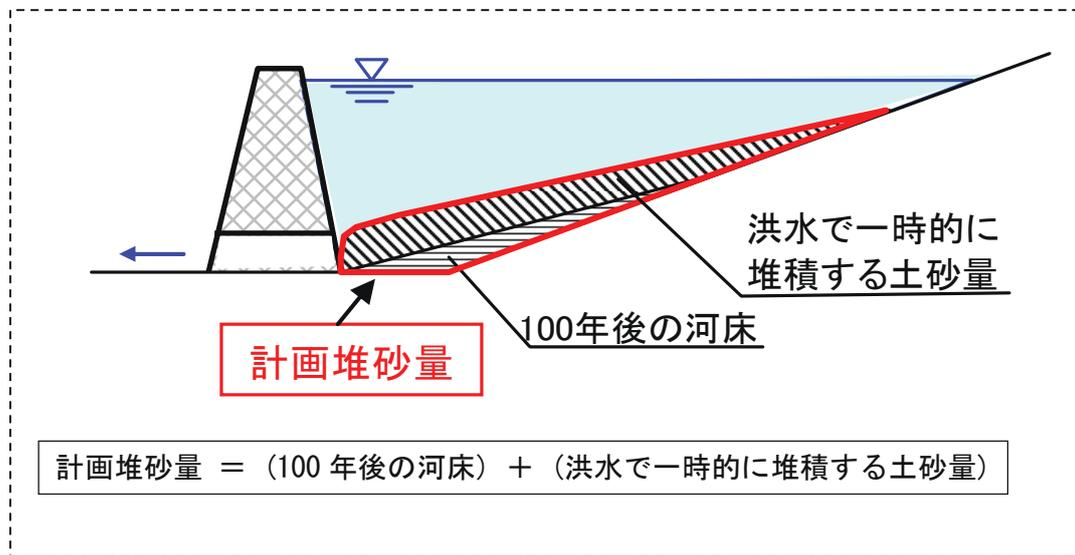
図 4-1 計画堆砂量の考え方（イメージ図）
