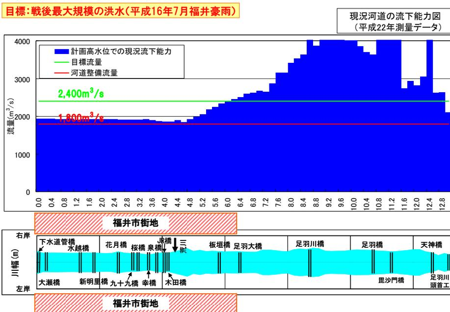
図 4-5 流下能力図 (足羽川)
