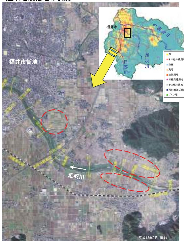
※写真は、今回の検討にあたり、遊水地のみにより、足羽川下流、日野川、九頭竜川における洪水時の水位を計画高水位以下に下げる場合の対策規模を想定したもの。
