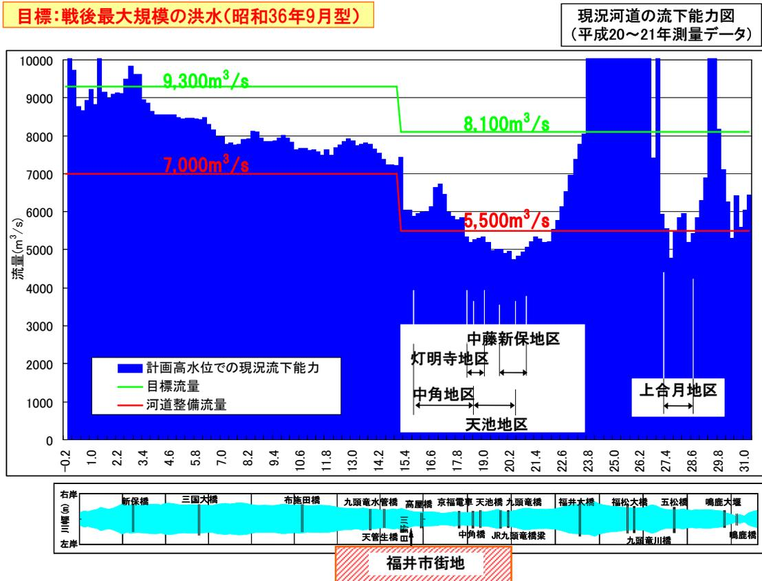
図 2-27 流下能力図（九頭竜川）
