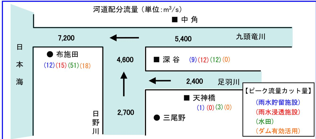
◆IV-5案⑬ 《輪中堤+宅地のかさ上げ+雨水貯留施設+雨水浸透施設+水田等の保全(機能の向上)+ダムの有効活用(ルールの見直し:2ダム)+河道の掘削(高水敷掘削)+堤防のかさ上げ》
