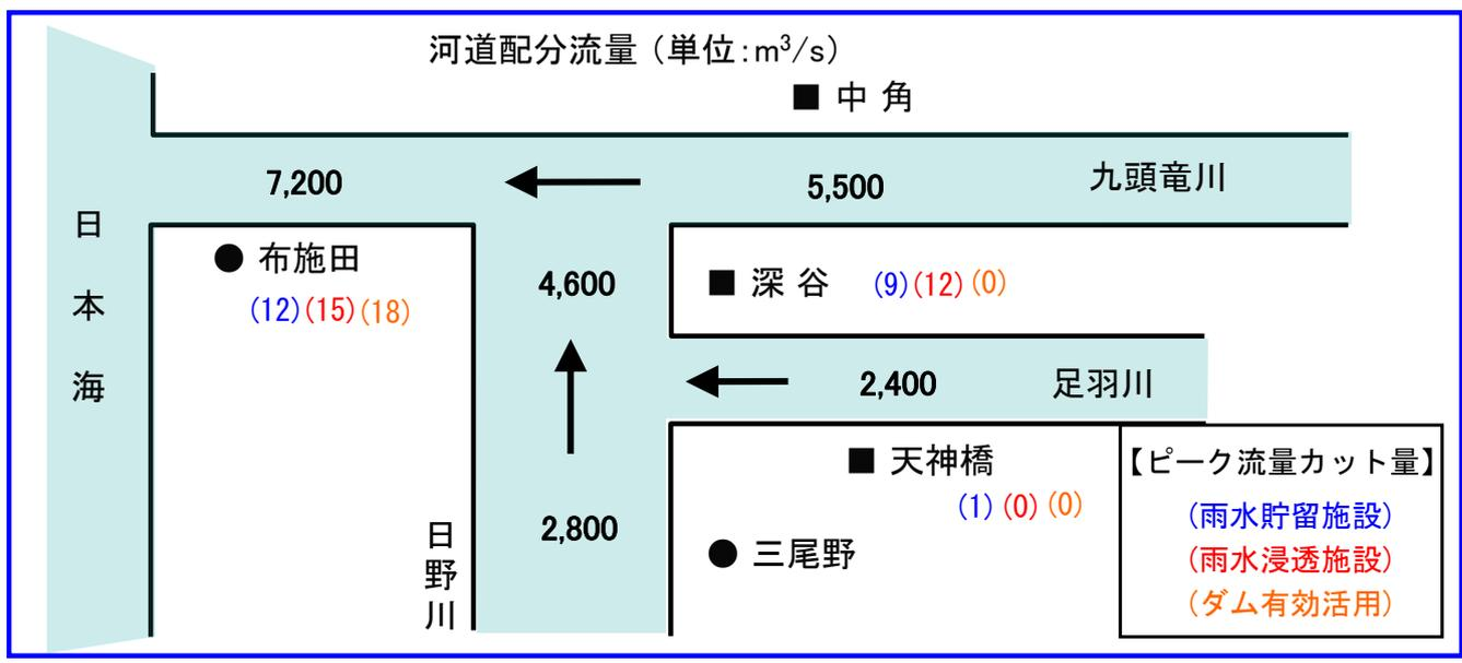
◆IV-6案②④ 《雨水貯留施設+雨水浸透施設+ダムの有効活用(ルールの見直し:2ダム)+河道の掘削(高水敷掘削)+堤防のかさ上げ》
