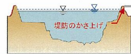
河道の掘削(高水敷)+堤防のかさ上げイメージ(足羽川下流)
