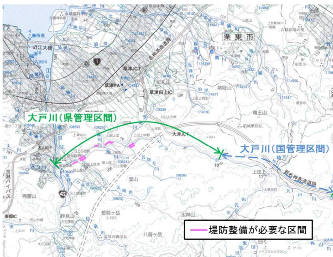
図 2.3-3 大戸川における県管理区間の範囲と堤防整備が必要な区間
