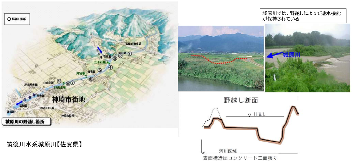
図 4.2-25 部分的に低い堤防の存置の候補地
