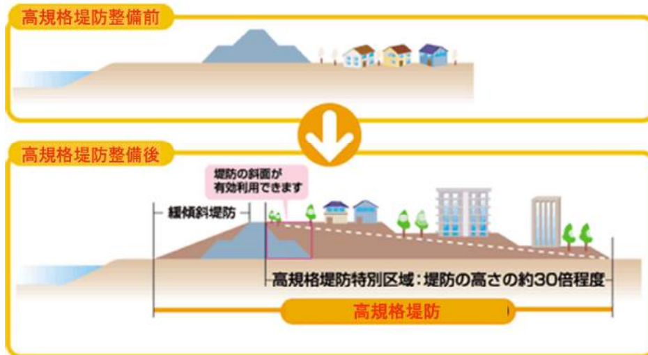
図 4.2-17 高規格堤防の概要
