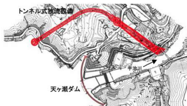
図 2.4-4 天ヶ瀬ダム再開発による放流能力の増強
