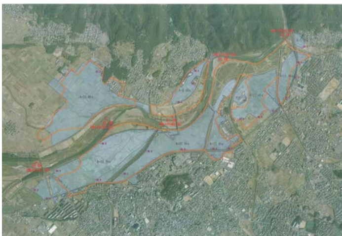
亀岡浸水区域(痕跡調査より作成)
